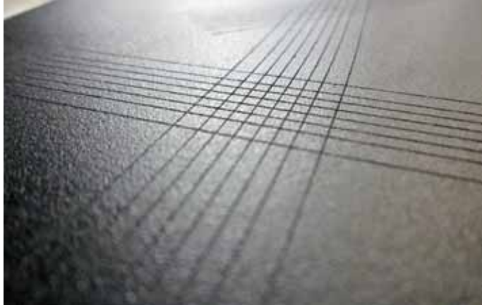
Der Gitterschnitttest auf der Pulverlackierung belegt die Oberflächengüte
