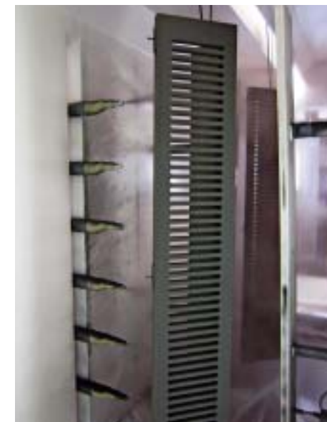
/ Elektrostatische Applikation: Selbst Ausschnitte und Ausfräsungen werden beschichtet. (Foto: Sauter)
