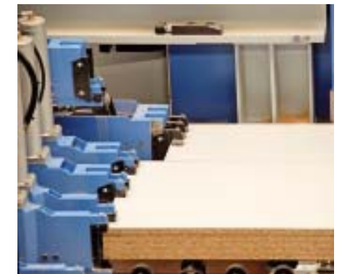
1 Die separat verfahrbare Spannzanze des Power Concepts steigert den Materialdurchsatz.
