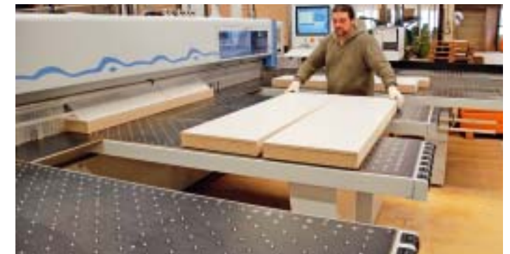
1 Die leicht verschiebbaren, 800 mm breiten Luftkissentische bieten eine mobile Arbeits- und Ablagefläche in ergonomischer Tischhöhe.
