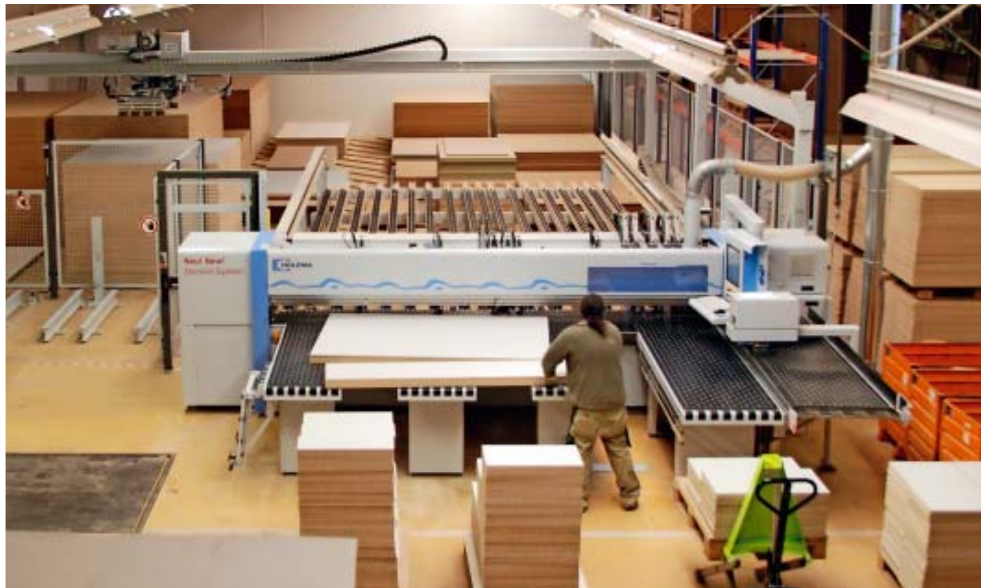
1 Vereint automatisiertes Plattenhandling und hohe Schnittleistung: Die räumlich bestens integrierte Säge-Lager-Kombination von Holzma und Bargstedt bei der Sauter GmbH. (BM-Fotos: Manfred Maier)
