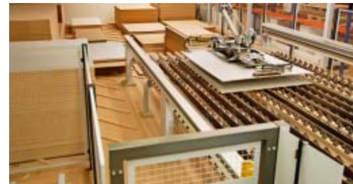
1 Lückenloser Materialfluss: Der Vorstapeltisch vermeidet Wartezeiten an der Plattenaufteilsäge.
