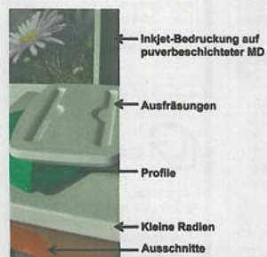
Abbildung 2 Gestaltungsmöglichkeiten bei der Pulverbeschichtung von MDF
